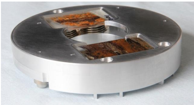
探针片样品台(长宽47.7 x 27mm, 厚约3mm)
